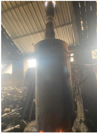
Gambar. 10 Prose Perebusan Sari Kedelai
