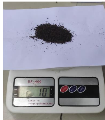
Gambar 4. Menimbang Serbuk Selulosa Kulit pisang raja sebesar 10 gr dan dimasukkan kedalam wadah kaca
