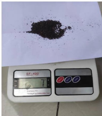
Gambar 3. Menimbang Serbuk Selulosa Kulit pisang raja sebesar 7 gr dan dimasukkan kedalam wadah kaca
