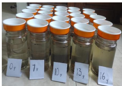
Gambar 9. Mengontakkan serbuk selulosa kulit pisang raja dengan sampel air yang mengandung Fe selama 2 jam
