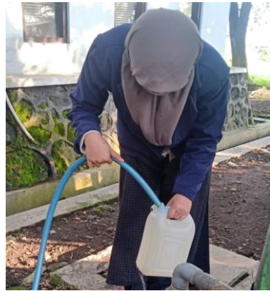
Gambar 2. Mengambil sampel air bersih hingga penuh agar tidak terjadi aerasi
