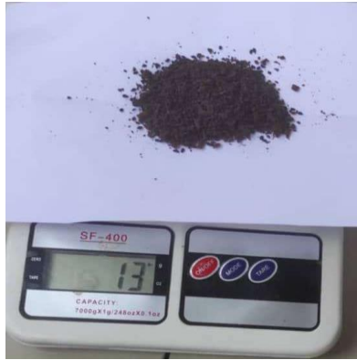
Gambar 5. Menimbang Serbuk Selulosa Kulit pisang raja sebesar 13 gr dan dimasukkan kedalam wadah kaca
