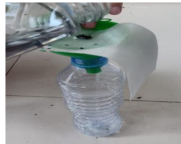
Gambar 10. Pemisahan adsorben dengan sampel air yang mengandung Fe menggunakan kertas saring
