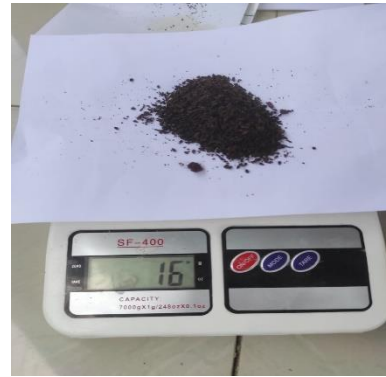
Gambar 6. Menimbang Serbuk Selulosa Kulit pisang raja sebesar 16 gr dan dimasukkan kedalam wadah kaca
