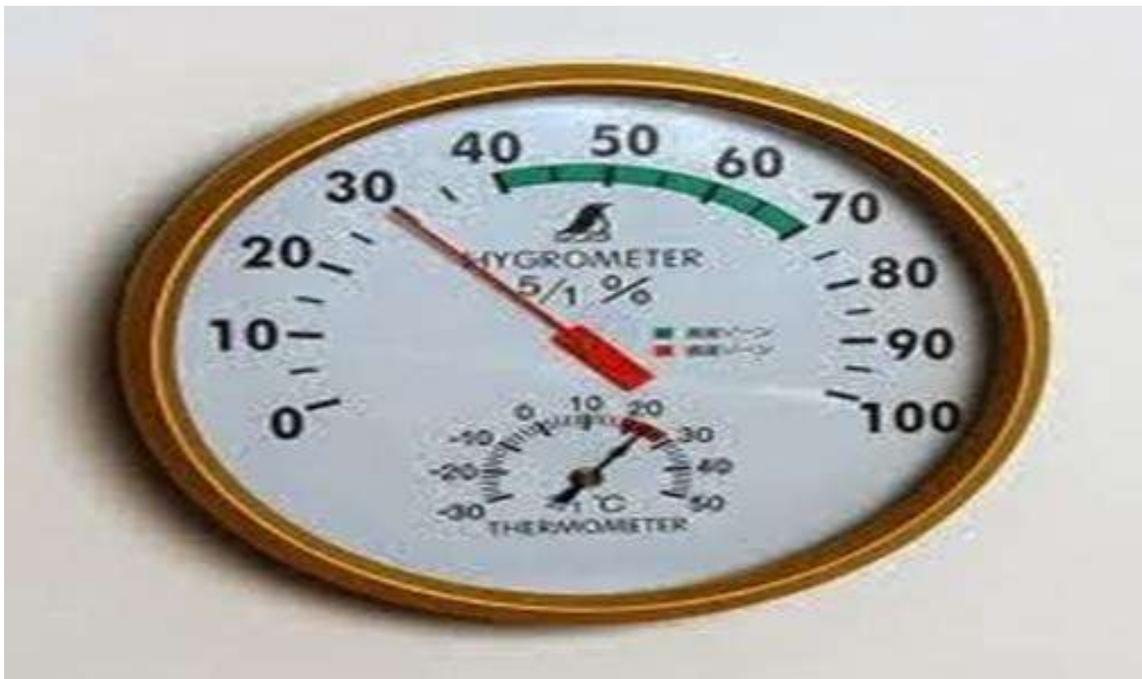
**Gambar 3.9** Pengukur Kelembaban Udara
