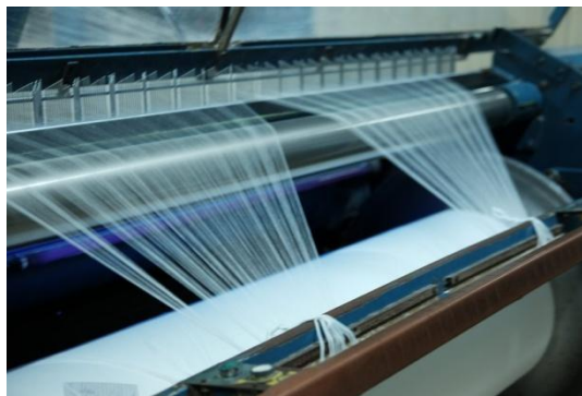
Gambar 4. Proses Penenunan Menggunakan Mesin Air Jet Loom
