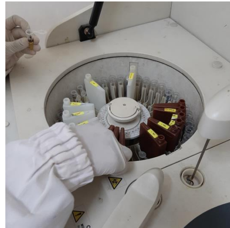
Sampel pada mikrotube dimasukkan ke dalam Mindray BS-200
