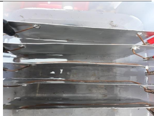
Gamabr 11 pemasangan plat aluminium didalam bak
