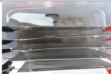
Gambar 17 plat Al bereaksi dengan sampel air hujan terjadi gelembung
