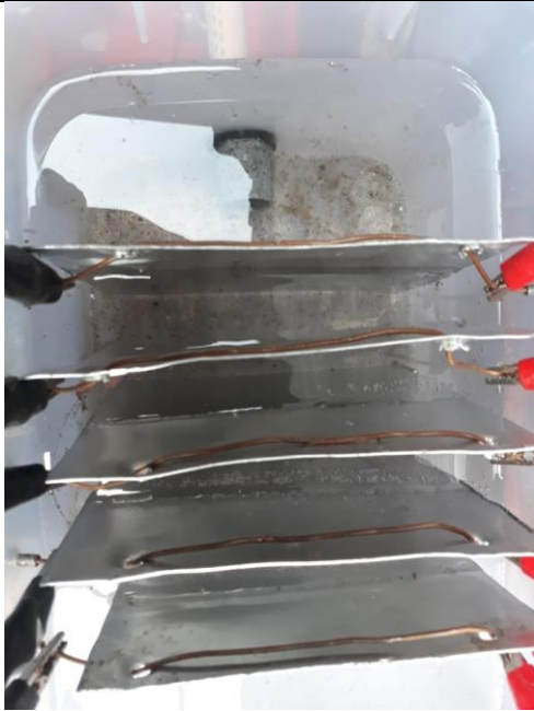
Gambar 19 terjadi flokulasi pada proses Elektrokoagulasi
