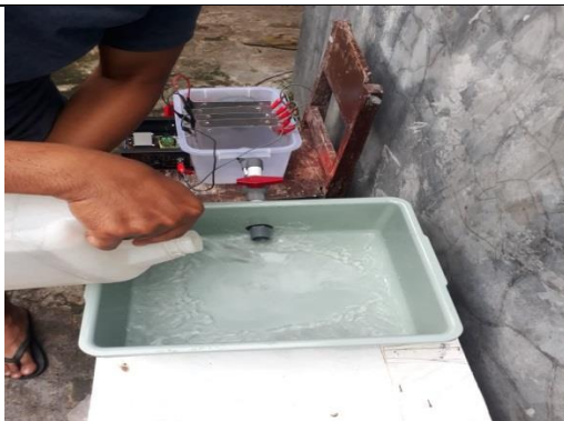
Gambar 15 proses memasukan sampel air hujan ke dalam inlet
