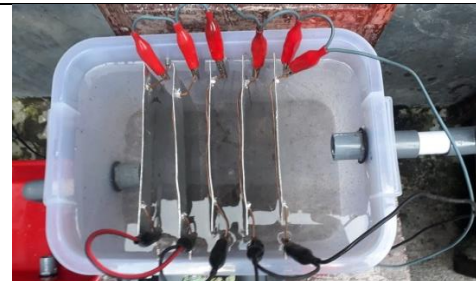
Gambar 12 proses pemasangan penjapit buaya dengan merangkai dengan aluminium
