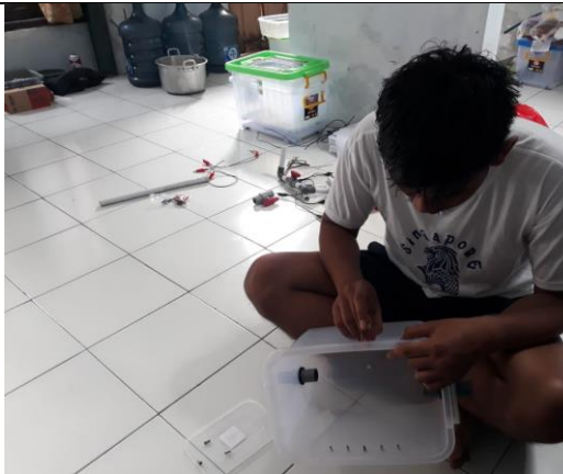
Gambar 7 kemudian lobangi bak sebagai penyangga aluminium dengan tembaga
