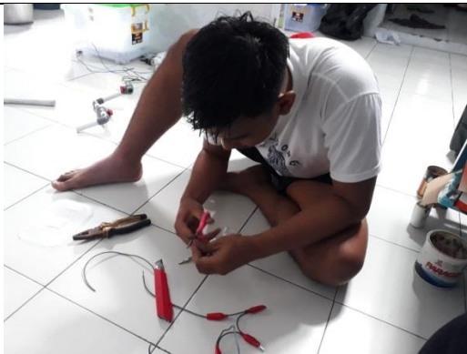
Gambar 8 proses selanjutnya dengan memotong kawat tembaga sesuai dengan ukuran
