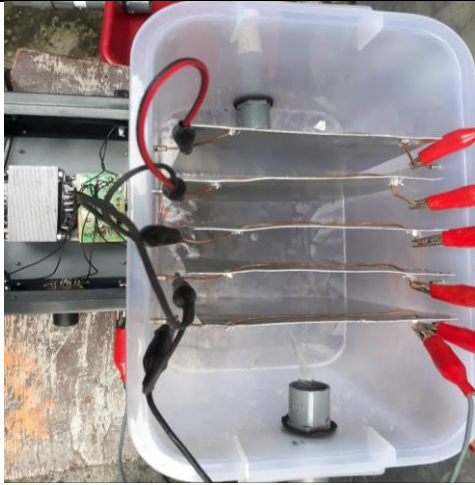
Gambar 13 capit buaya terhubung Al dirangkai dengan power supply dengan variasi waktu dan arus yang ditentukan
