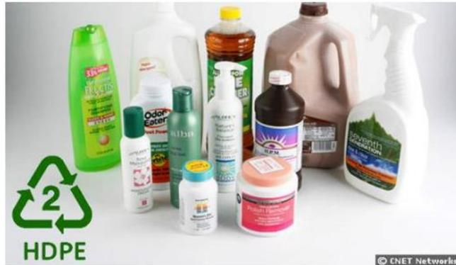
Gambar 2.9 Produk botol yang terbuat dari plastik HDPE
