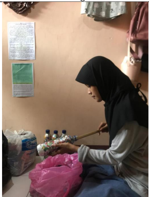
Gambar 12 : Proses pembuatan ecobrick dengan memadatkan sampah plastik kedalam botol mineral dengan tongkat bambu
