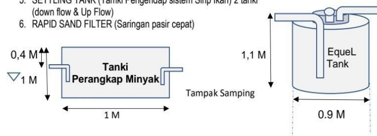
Gambar 4. Detail Dimensi Unit Pengolah Air Limbah
