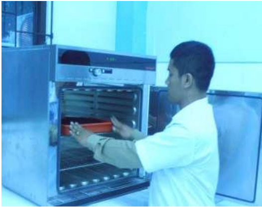
Reaktivasi Carbon Aktif di Lab BBTCL
