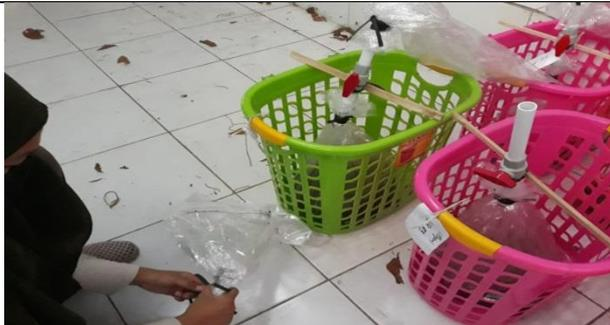
a. Mengikat plastik yang berisi gas yang telah dipindahkan tadi pada alat penguji nyala api
