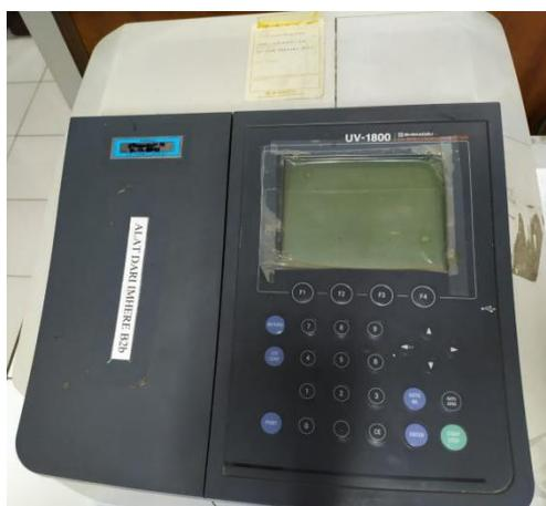
**Gambar 2.9** Spektrofotometri UV-Vis
