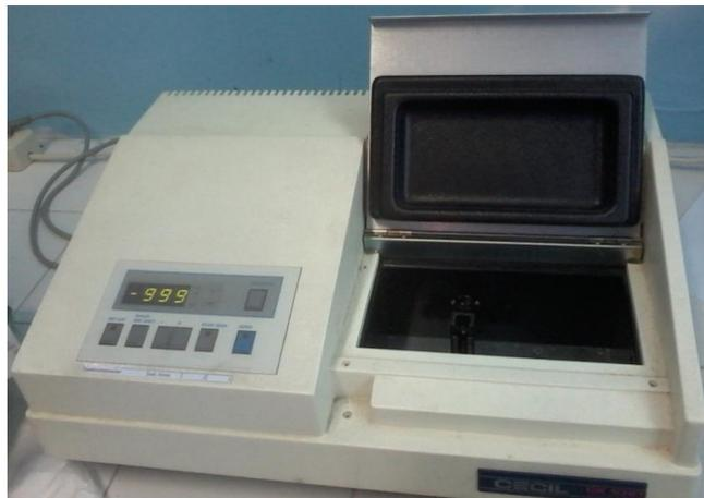
**Gambar 2.5.** Spektrofotometer UV-Vis CECIL CE 1021
