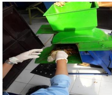
**Proses memasukkan sampah pada mesin pencacah**
