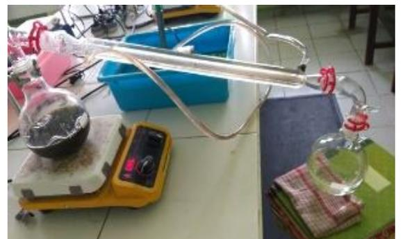
Gambar 6. Proses destilasi uap
