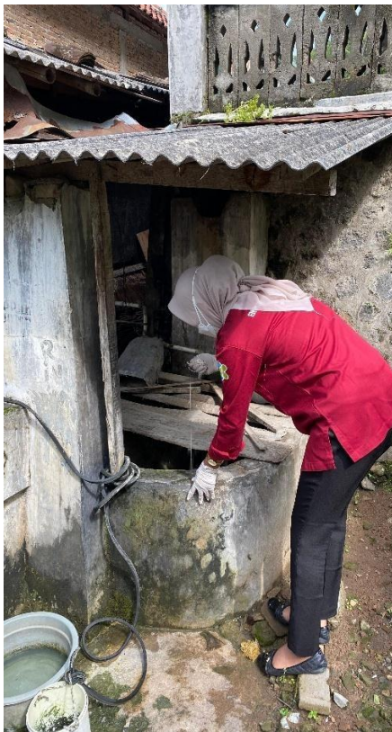
Gambar 5 Pengambilan Sampel Bakteriologis Air Sumur Gali
