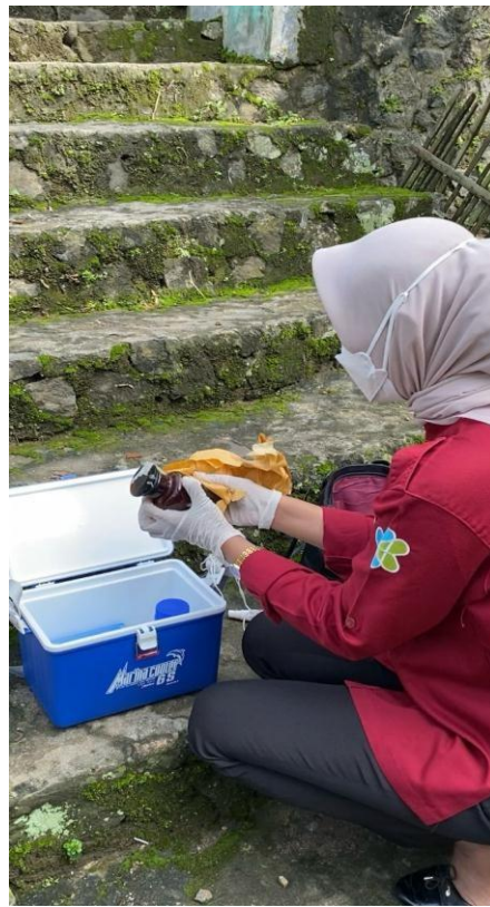
Gambar 5 Pengambilan Sampel Bakteriologis Air Sumur Gali
