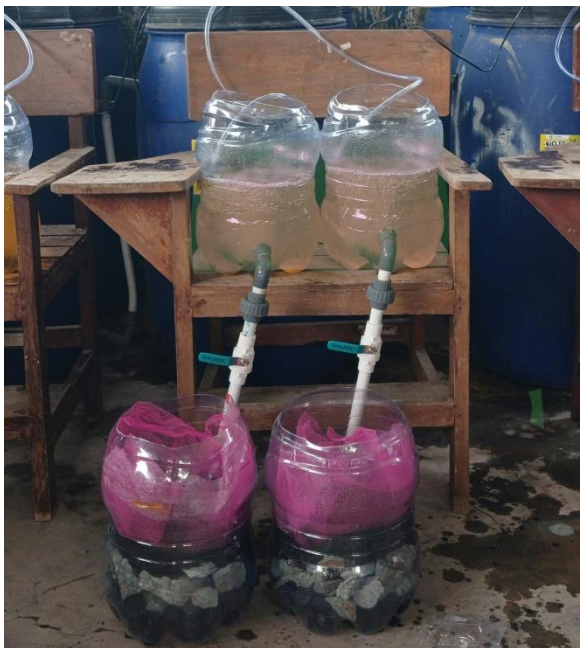
Gambar 11. Proses Aerasi dan Filtrasi
