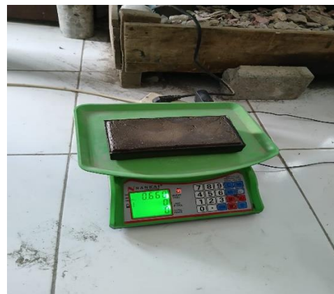
Gambar 6. Penimbangan sebelum di uji tekan
