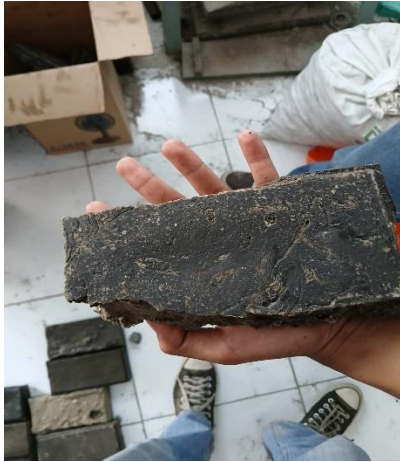
Gambar 9. Paving block hancur setelah di uji tekan
