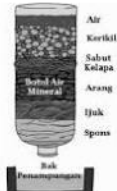
Gambar II.5 Metode Filtrasi Sederhana
