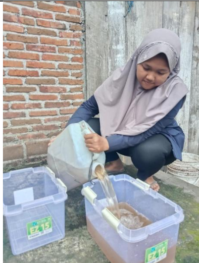
Gambar 3 Penuangan Air Besi (Fe) Pada Bak Aerasi
