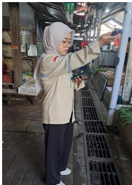
Gambar V. 11 Melakukan pengukuran pencahayaan menggunakan alat Lux Meter
