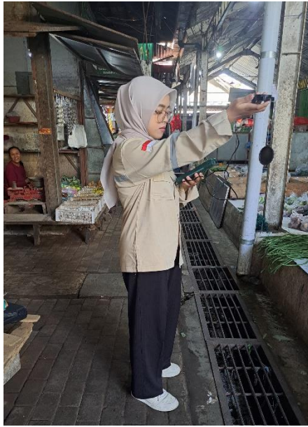
Gambar V. 13 Pengukuran pencahayaan pasar
