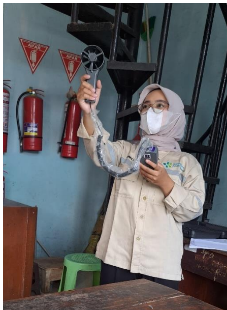
Gambar V. 3 Pengukuran suhu, kecepatan laju udara, dan kelembaban di kantor pengelola pasar
